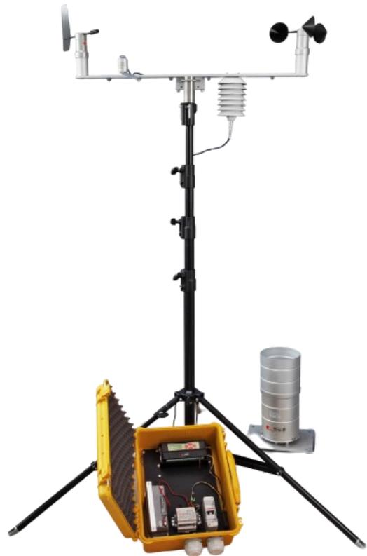
► Per una soluzione portatile, il pacchetto KME deve essere dotato di custodia portatile e tripode. LSI LASTEM è in grado di fornire la custodia ELF432 ed il tripode telescopico DYA340.
